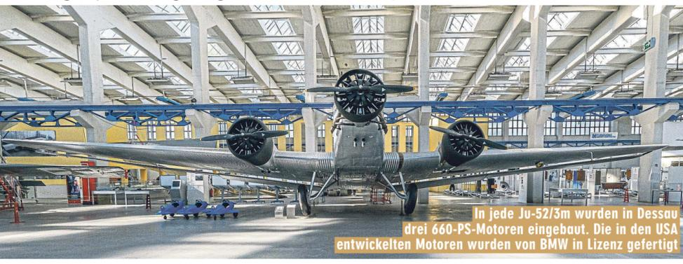
In jede Ju-52/3m wurden in Dessau drei 660-PS-Motoren eingebaut. Die in den USA entwickelten Motoren wurden von BMW in Lizenz gefertigt
